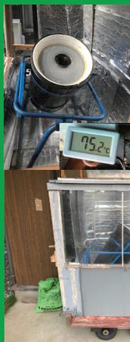
私たちは、海の未利用資源を農業に活用するための工夫として、今回は堆肥製作にチャレンジしました。しかし、堆肥作りには通常数か月かかるため、農家さんから教わった方法(加熱と攪拌)を採用し、昨年度から始めている太陽の熱で発酵が促進され手回しで攪拌し3日程で堆肥を作ることができる、手作り堆肥製造マシンの試作機第一号が完成しました。(詳しくはHPのSDGsの取り組みで)
